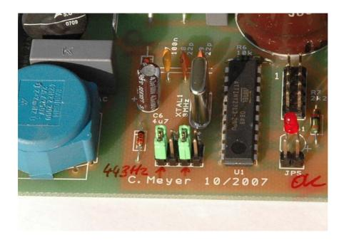
Jumper (wie auf älteren PC-Mainboards oder Festplatten verwendet) zur Frequenz-Feineinstellung, falls abweichende Stimmung gewünscht: Von links nach rechts JP1, JP2, JP3, JP4 (siehe obige Tabelle). Gezeigt ist die Einstellung für A=445 Hz. Vor der Einstellung der Jumper Orgel unbedingt vom Lichtnetz trennen, alle Bauteile einschließlich des Jumper-Steckfeldes führen Netzspannung!
