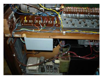
Vorbildlicher Einbau des Wandlers in einem Metallgehäuse (mit Masse verbunden!) in einer A-100.
