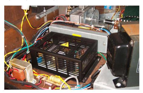
SWC-60 in Metallgehäuse (ausgeschlachtetes PC-Netzteil) montiert in einer C3. Die Bauteile vorn links gehören zum Leslie-Kit.
