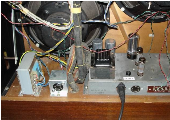
Vorschalt-Trafo und umgebautes Netzteil-Chassis mit Sicherung und Kaltgerätebuchse in einer A-100
