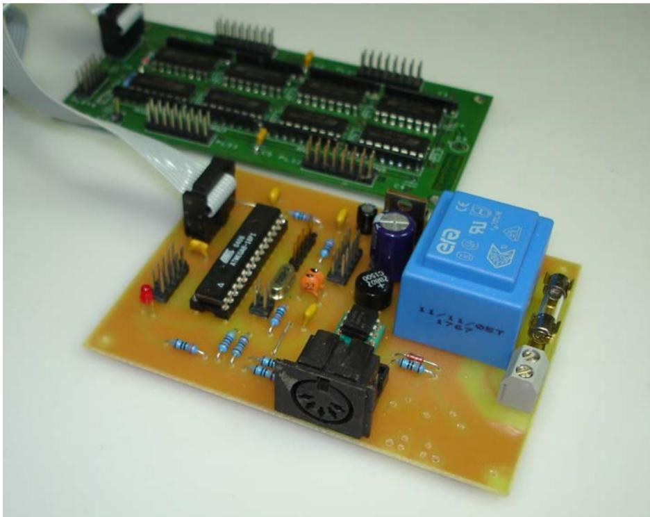
Controller- und Scan-Platine(n) werden über ein einfaches Flachbandkabel eir im Bild gezeigt miteinander verbunden (bis zu 1m lang, Ausgang der Scan-Platine Steckverbinder **PL04**). Weitere Scan-Platinen werden einfach in Reihe geschaltet, indem man jeweils den Steckverbinder **PL04a** mit **PL04** der nächsten Scan-Platine verbindet. Achten Sie auf die richtige Polung, Pin 1 ist mit einem Punkt und einer auf der Platine eingezätzten "1" gekennzeichnet.
